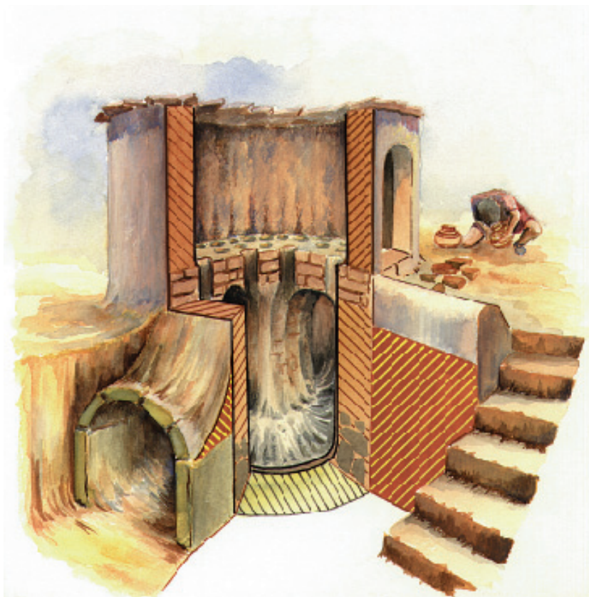
Reproducció d'un forn ceràmic ibèric. Alcalà de Xúquer (Albacete). Reproducción de un horno cerámico ibérico. Alcalá del Júcar (Albacete).
